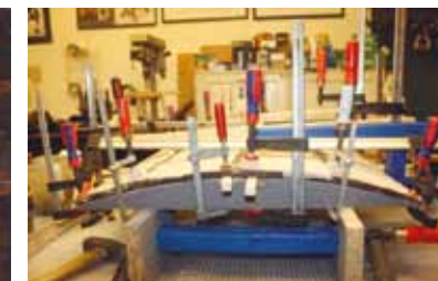
2 — Faza spajanja dasaka nakon čišćenja spojeva
