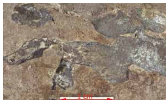
3b — Makrofotografija lema na vanjskoj strani posude
