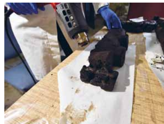
9 — Uklanjanje vidljivog PEG-a nakon sušenja drvene građe vrućim zrakom
