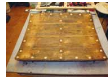
4 — Raster dvostupanjskih rupa na nosiocu sa podlošcima
