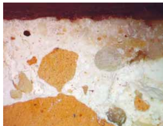
6 — Presjek ulomka stropne oslikane žbuke
