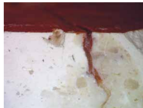
6a — Presjek ulomka zidne oslikane žbuke
