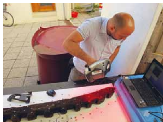
4 — 3D skeniranje drvene građe
