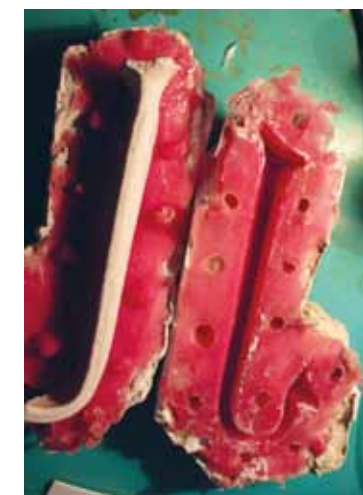
2 — Kalup od silikona za izradu odljeva ručke
