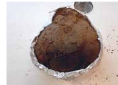
1 — Posuda u bloku zemlje, izvađena in situ
