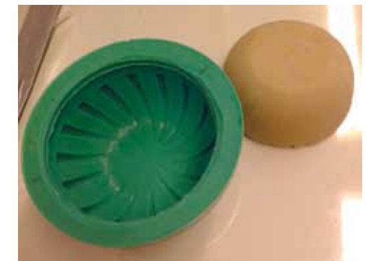
2 — Pozitiv i negativ kalupa
