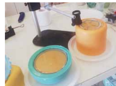
3 — Dvodijelni kalup je fiksiran u ispravnom položaju te je između stijenki uliven epoksid
